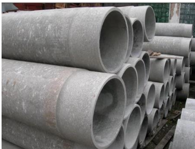
Рисунок 3. Трубы, в состав которых входит хризотил-асбест
